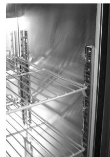
Steek de onderste uitstekende poot van de geleider in de verticale steun en kantel de geleider naar boven zodat de bovenste poot in de uitspanning erboven kan worden geplaatst. Controleer of de geleiders parallel aan elkaar zijn en zich op gelijke hoogte bevinden.
