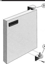
Wenn zum Eintransport wenig Platz zur Verfügung steht, ist es möglich, die Türen auszubauen. Entfernen Sie die Schrauben aus dem unteren Scharnier A. Die Tür kann aus dem oberen Scharnier B herausgezogen werden.
